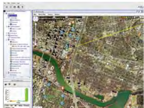
无线管理器显示的基于地图的视图，提供了所有网络层的实时性能数据
